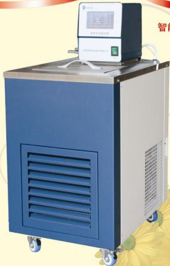
智能恒温循环器又称低温浴槽，是自带制冷和加热的高精度恒温源。它广泛应用于石油、化工、冶金、医药、生化、物性测试及化学分析、高等院校、工厂实验室及计量质检等研究部门。可在浴槽内进行恒温实验，亦可通过软管与其他设备相连，作为恒温源配套使用，如旋转蒸发器、电泳仪、粘度计、医用冷帽、降温毯等，或用于给其它设备进行循环冷却，如电镜、分子泵、离子泵、扩散泵、微波治疗机等。
